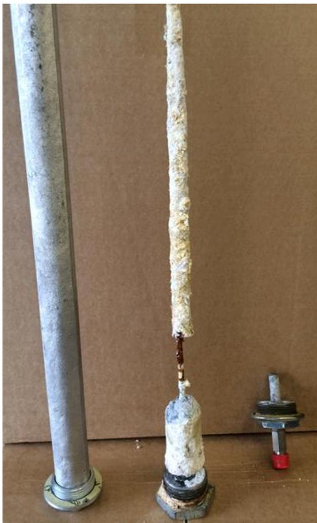
Das linke Bild zeigt, wie sich eine Magnesium bzw. **Opferanode** in einem Trinkwassererwärmer mit der Zeit abbaut.
